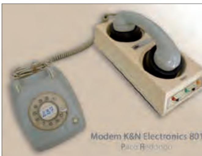
Modem acústico de tipo zapatilla para la transmisión y recepción de ficheros entre ordenadores.
